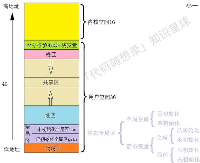
如上图，从高地址到低地址，一个程序由命令行参数和环境变量、栈、文件映射区、堆、BSS段、数据段、代码段组成。
