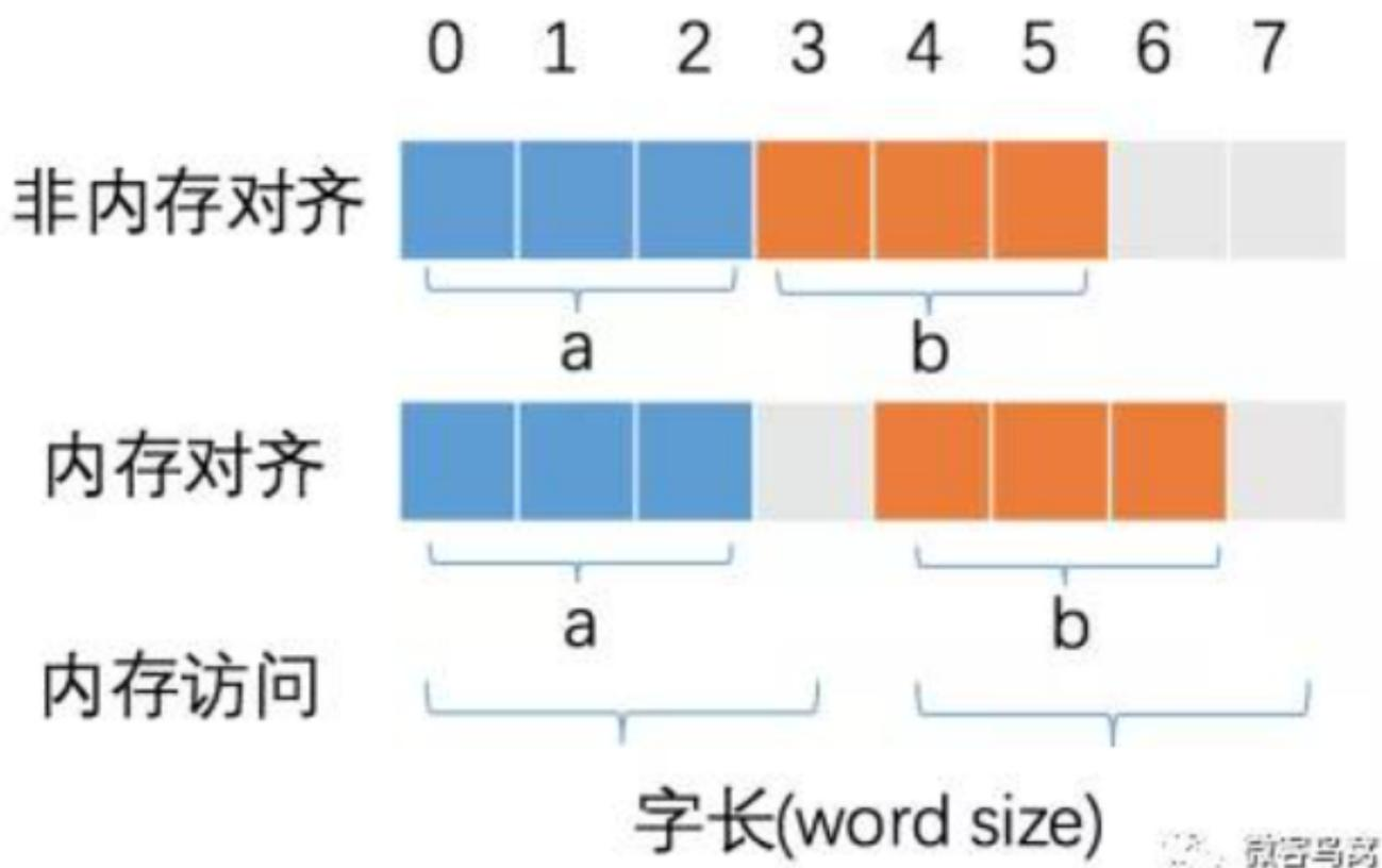
变量 a、b 各占据 3 字节的空间，内存对齐后，a、b 占据 4 字节空间，CPU 读取 b 变量的值只需要进行一次内存访问。如果不进行内存对齐，CPU 读取 b 变量的值需要进行 2 次内存访问。第一次访问得到 b 变量的第 1 个字节，第二次访问得到 b 变量的后两个字节。
